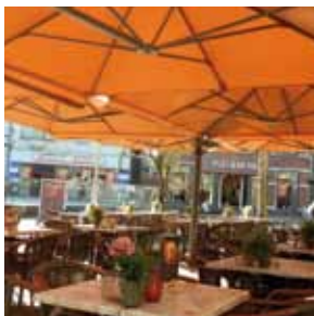
Afruitsbare doekgoten waarmee parasols onderling verbonden worden zorgen voor de afvoer van het regenwater.
